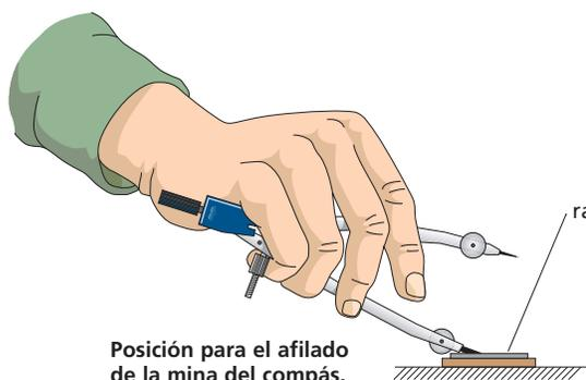
Posición para el afilado de la mina del compás.
