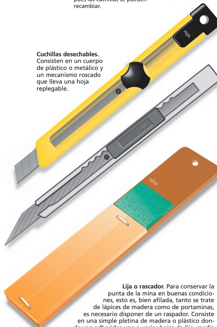
Lija o rascador. Para conservar la punta de la mina en buenas condiciones, esto es, bien afilada, tanto se trate de lápices de madera como de portaminas, es necesario disponer de un raspador. Consiste en una simple pletina de madera o plástico donde van adheridas una o varias hojas de lija, media y fina, para el afilado final.
