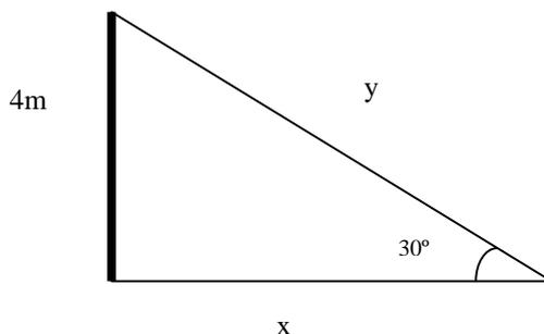
a)  $\text{tag } 30^\circ = 4/x \quad x = 4/\text{tag } 30^\circ \cong 6,93$ . Sujetaremos el cable a 6,93 m del poste
