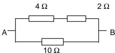
a) La rama de arriba tiene una resistencia equivalente de 6 Ω
