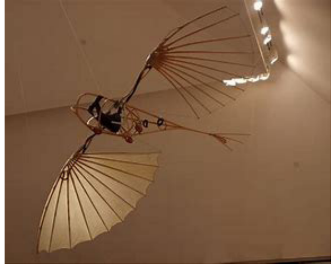
IMATGE B. Letatlin (1930-1932). Maqueta de màquina voladora feta de fusta, metall i corda, 350 × 270 × 230 cm.
