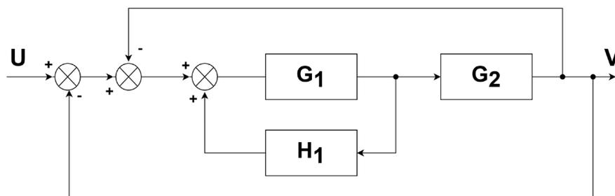
4.2. Simplifica el siguiente sistema de control hasta conseguir la función de transferencia del sistema. (2,5 puntos)
